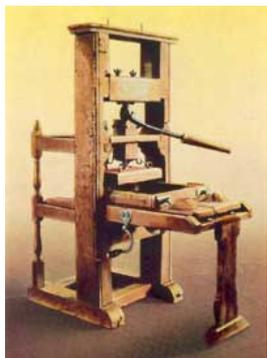
El marco de madera se ajusta a una mesa por medio de bisagras, que permiten subirlo y bajarlo para colocar y retirar los pliegos impresos
