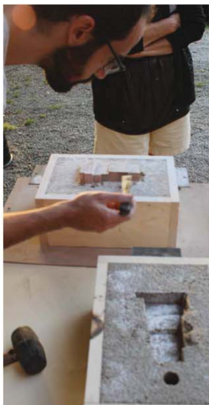
Fig. 2: Participantes del taller MMDA-14 preparando moldes de arena para fundición de aluminio.
